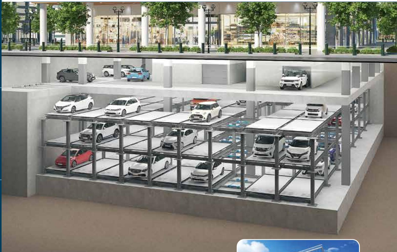
GPS-4は、省スペースで定評のあるパズル式駐車場「スミパークエース」に高速リフトを付加することにより高速・大容量での運用を可能とした駐車システムです。
